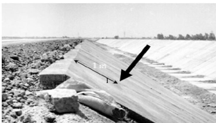
شکل (۱): محل آزمایش روش اول (چکش و میخ فولادی) در کلیه پانل‌های مورد آزمایش
